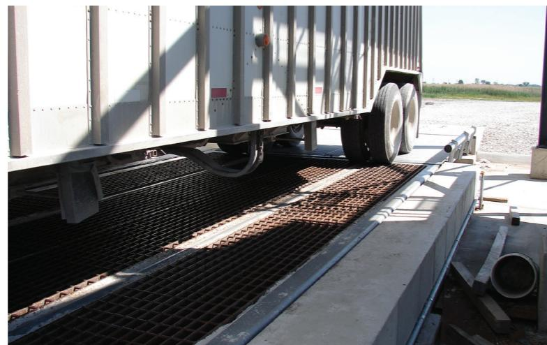
Les processus sont rationalisés grâce à l'intégration de décharges de grain directement dans le pont-bascule.
