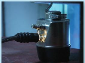
Des tests indépendants ont révélé que les cellules de pesée POWERCELL® PDX® pouvaient résister à une intensité allant jusqu'à 80 000 ampères. Pour en savoir plus et voir une vidéo du test, rendez-vous sur le lien ci-dessous.
