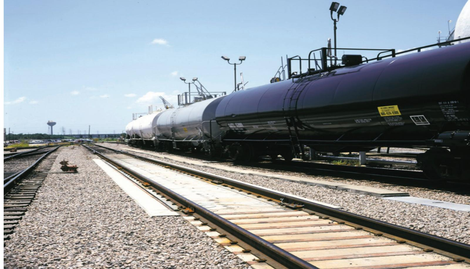
mécaniques situés en dessous du pont et les remplacer par des installations conçues sur mesure pour les cellules de pesée 90 tonnes POWERCELL PDX. En remplaçant simultanément les rails du pont existant, le client obtiendrait des performances semblables à celles d'un nouveau pont-bascule pour véhicules sur rail pour un coût bien moins important. Compte tenu des performances et de la valeur ajoutée, le client n'a pas hésité un instant à mettre à niveau le pont-bascule pour véhicules sur rail.
